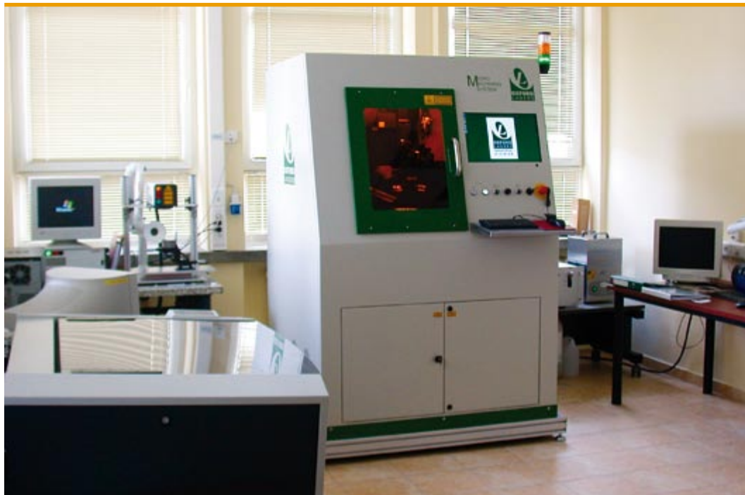
System laserowy z generacją wyższych harmonicznych zakupiony dla ITTA znajduje zastosowanie w mikroobróbce
